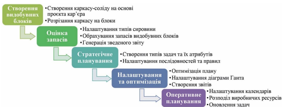
Рис. 2. Алгоритм процесу планування відкритих гірничих робіт за допомогою Micromine Scheduler
